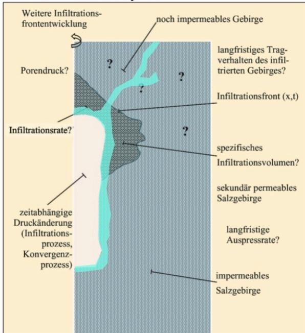
Figure 62. Schematic illustration of the geometry of the infiltrated volume and the relevant processes and parameters. Left picture After: Lux, K.-H., 2006. Zum langfristigen Tragverhalten von verschlossenen solegefüllten Salzkavernen – ein neuer Ansatz zu physikalischer Modellierung und numerischer Simulation: Rechnerische Analysen und grundlegende Erkenntnisse. *Erdöl, Erdgas, Kohle* 122, 150–158. Right picture: the preferential fingering proposed in this review.
