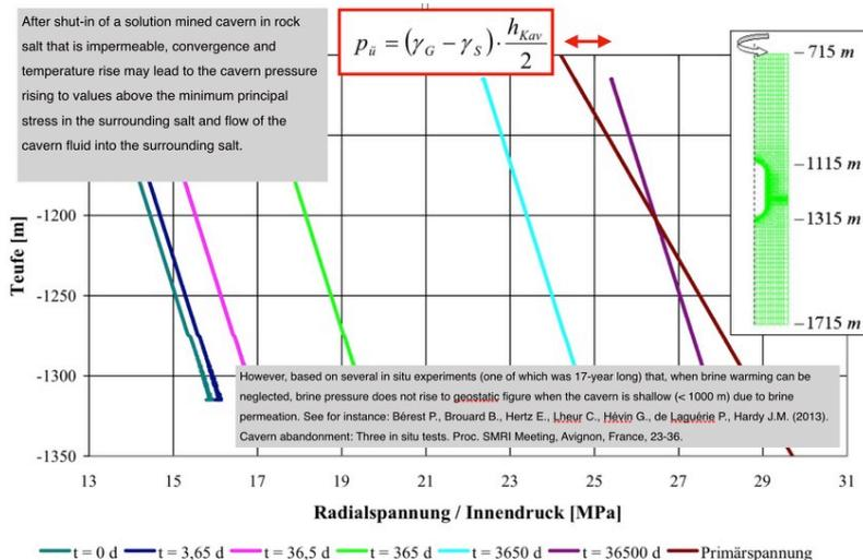
Bild 3.2 Darstellung des konvergenzbedingt ansteigenden Kaverneninnendruck in einer verschlossenen solegefüllten Kaverne, Lux (2006a)
